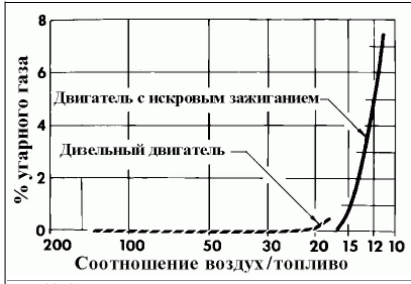
Рис. 88. Содержание угарного газа в выхлопных газах дизельных двигателей и двигателей с искровым зажиганием, представленное в виде функции от нагрузки на двигатель (соотношения воздух/топливо).
